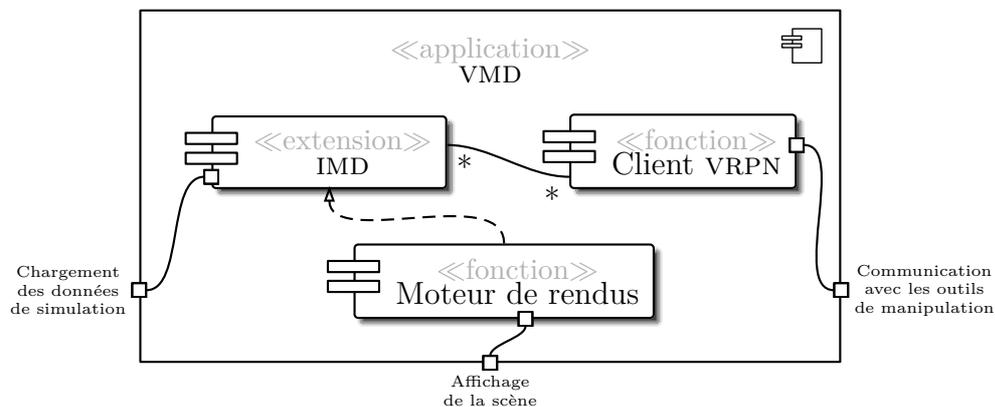
Figure 2.2 – Diagramme de composant UML du nœud VMD
